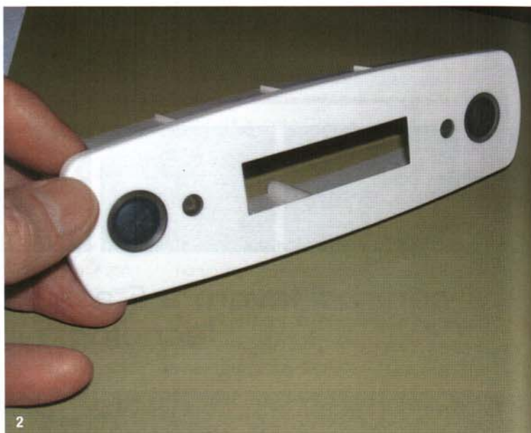
Figura 1 - Il pezzo: un "pannellino" per vasca o doccia a idromassaggio in due versioni (rossa e bianca). Composto di tre materiali (policarbonato trasparente, PMMA e poliuretano morbido PU per i tasti integrati), esso viene prodotto in un solo stampo che, con quattro impronte fornisce due pezzi ogni ciclo
