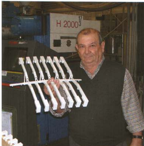
Fig. 7 – Il signor Lino Ragni, titolare della Fatar srl, con un "grappolo" di tasti stampati a parte e da applicare alla tastiera
