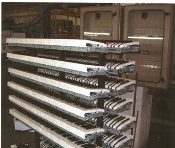
Fig. 9 - Tastiere complete pronte per il montaggio sui pianoforti
