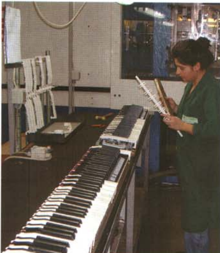
Fig. 8 – Una tastiera in fase di applicazione dei tasti
