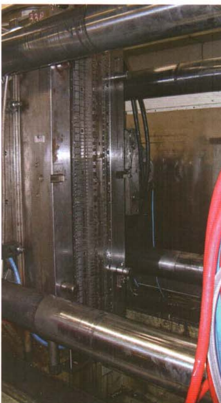
Fig. 6 - Lo stampo montato sulla pressa
